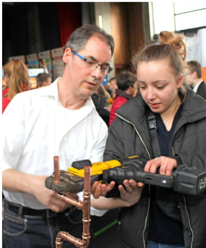
Wie wär's mit einem handwerklichen Beruf? Wie man beispielsweise ein Kupferrohr verpresst, durften interessierte Schüler beim Obersulmer Heizungsbaumeister Andreas Württemberger selbst ausprobieren.
